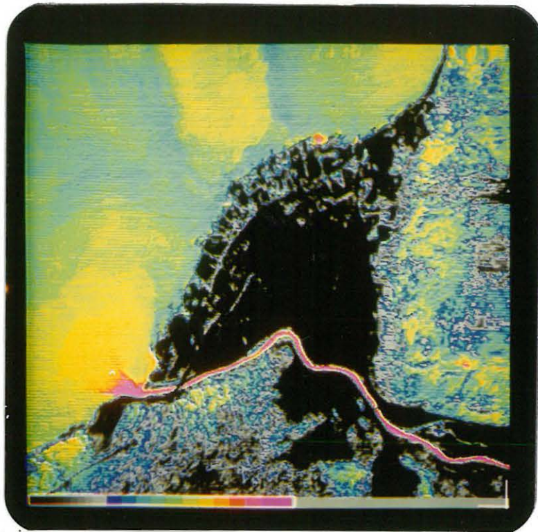
Abb. 10: Temperaturstufenbild. Farbklassifizierung der Wassertemperaturen, Bildverarbeitung, Bereich Weißenbach, Ausschnitt aus Abb. 7b.
